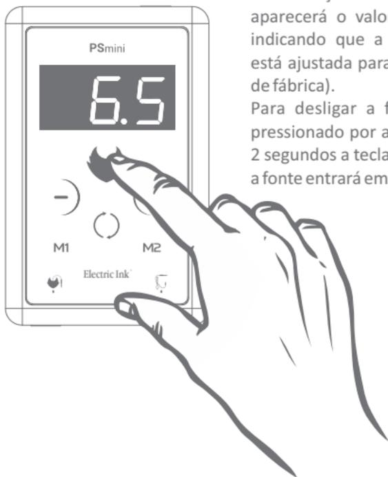
Observação: No primeiro uso aparecerá o valor 6,5 no display, indicando que a tensão de saída está ajustada para 6,5 Volts (ajuste de fábrica).
